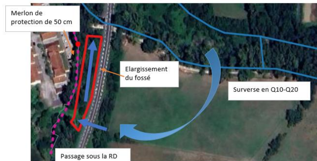
Figure 34 : Sécurisation du fossé en aval de la RD307
