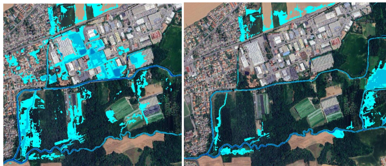
Figure 22 : Etat initial des inondations en Q5 (à gauche) et impact d'une large réouverture du champ d'expansion crue rive gauche de la Luyne à Marennes (à droite)
